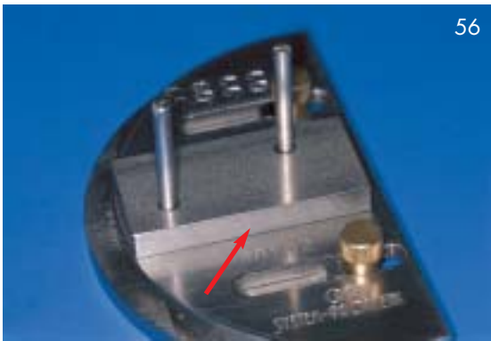
Abb. 56 und 57 Bei elongierten Zähnen wird der 5 mm-Distanzblock oberhalb der Fixierplatte entfernt...
