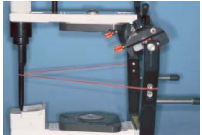
Abb. 5 Die Kauebene im Artikulator wird immer noch willkürlich mit einem Gummiband dargestellt.
